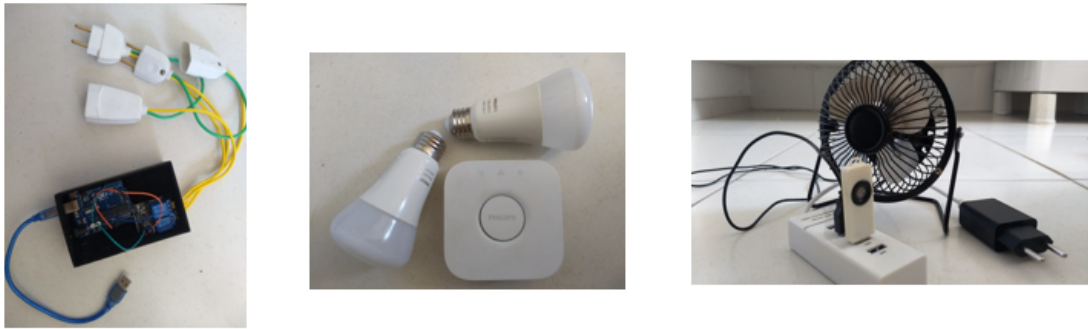
Figura IV.10: Controlador dos atuadores de vento e cheiro, atuador de luz e atuador de cheiro.
