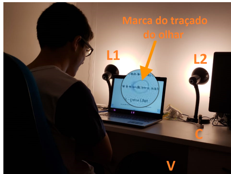
Figura V.5: Montagem do experimento com a utilização de computador para ler o texto, lâmpadas RGB, ventilador e difusor de cheiro.
