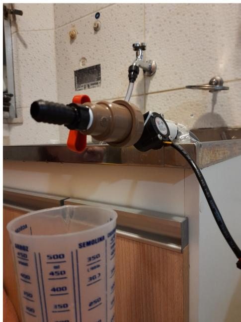
Figura 4.1: Experimento de aferição da precisão sensor de vazão
