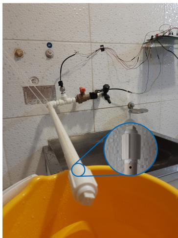
Figura 4.8: Experimento para teste de pequenos vazamentos
