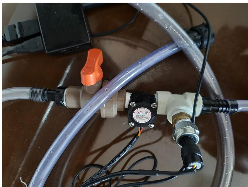
Figura D.6: Montagem hidráulica dos sensores de vazão e pressão em uma mangueira
