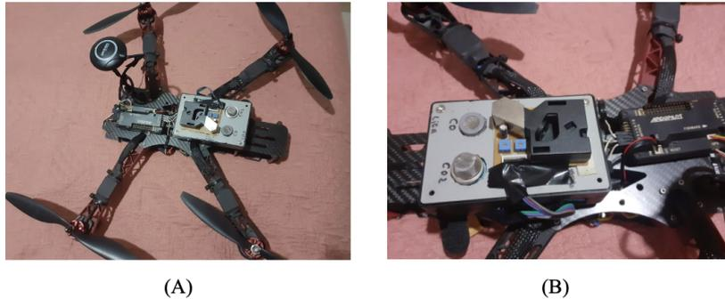
Figura 4.12: Dispositivo proposto associado ao VANT. (Fonte: O próprio autor)
