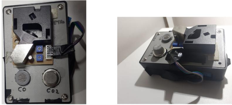
Figura 4.11: Dispositivo proposto para o monitoramento do ar. (Fonte: O próprio autor)
