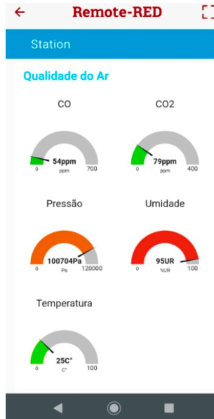
Figura 5.2: Sistema em NodeRed para validação do monitoramento em um ambiente Indoor em tempo real. (Fonte: O próprio autor)
