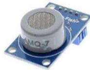
Figura 4.5: Sensor de CO, modelo MQ-7. (Fonte: Datasheet da HUANWEI)
