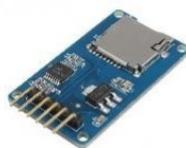
Figura 4.9: Dispositivo de armazenamento dos dados, no padrão micro SD. Fonte: [DATASHEET, 2018].
