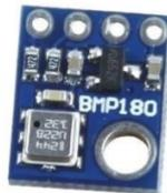
Figura 4.8: Exemplo de barômetro utilizado para medições de pressão atmosférica em Pascal BMP180. (Fonte: Datasheet do BMP180)
