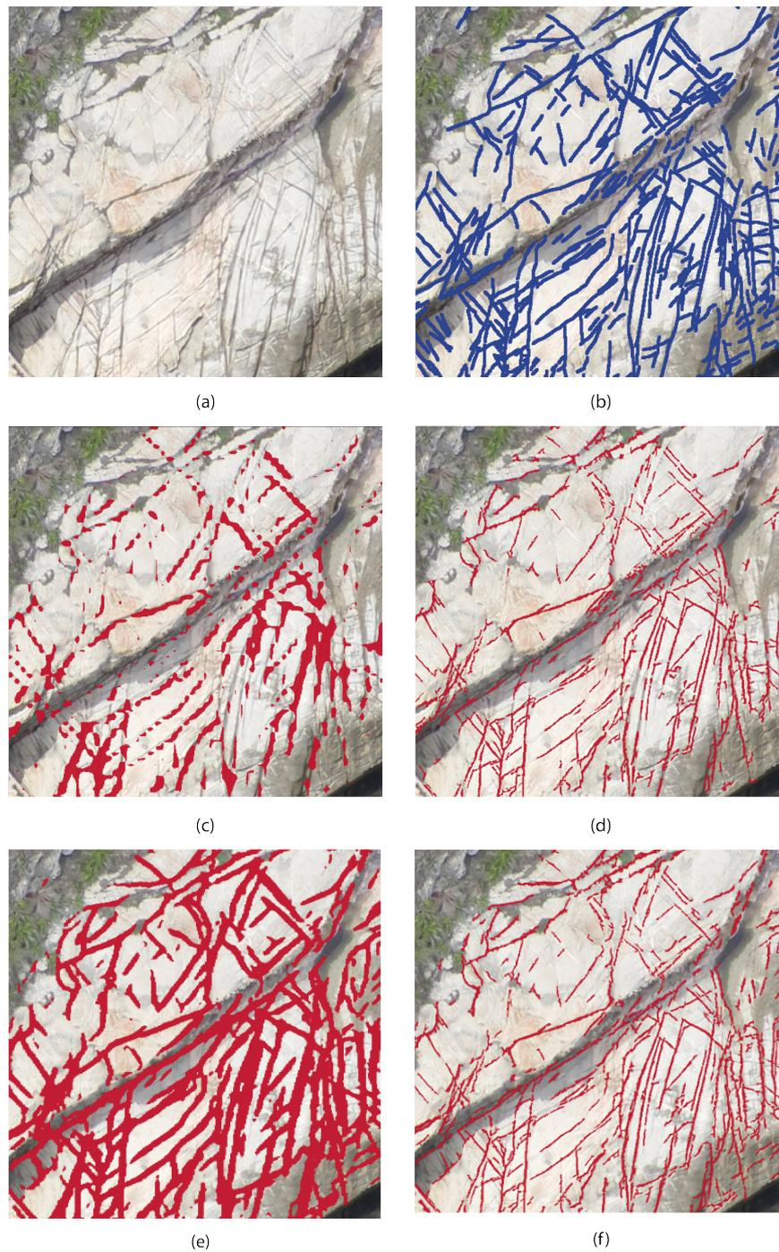
Figura 17 – Resultados do modelo de segmentação semântica e pós-processamento. a) Imagem original. b) Anotações de *ground truth*. c) Segmentação predita gerada pelo modelo DenseNet 264. d) Resultado usando o fluxo de trabalho de pós-processamento proposto nas previsões do modelo Densenet 264. e) Segmentação predita pelo modelo DenseNet 161. f) Resultado com pós-processamento na previsão do modelo DenseNet 161.
