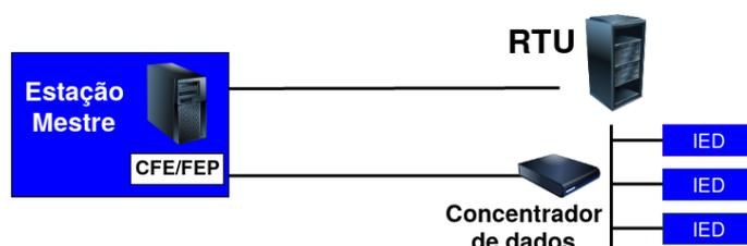
Figura 8 – Componentes básicos de um sistema SCADA.
