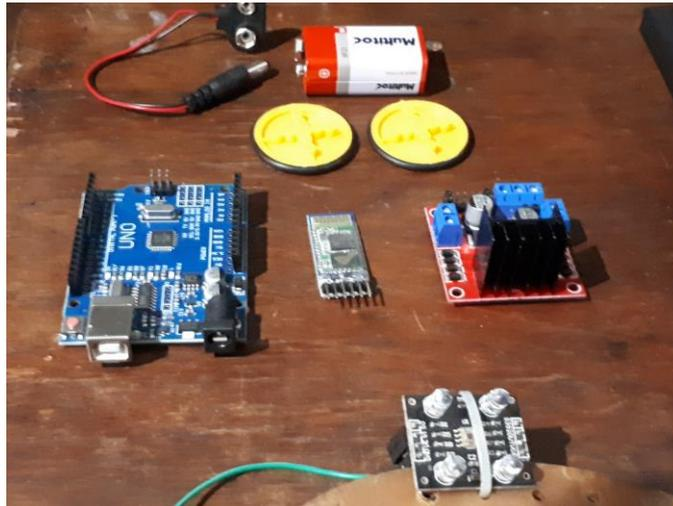
**Figura 3** - Outros componentes do robô, uma bateria de 9V com plugue de conexão, um par de rodas mais finas, uma placa de interface Arduíno UNO R3, um sensor bluetooth HC-05, uma ponte H L298N e um sensor de cores TCS230 RGB.
