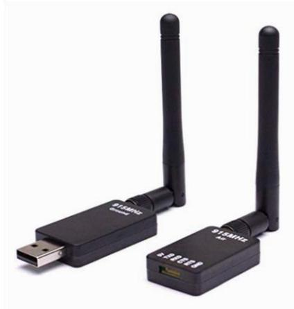
Utiliza-se um módulo de telemetria ReadyToSky 3DR que trabalha em 915Mhz. O módulo é o adequado para alcances de 1 a 2 Km, no máximo, para diversos tipos de testes e controle .
