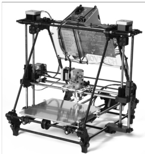
Figura 48 – Impressora Movtech 3D do tipo "impressora de extrusão"
