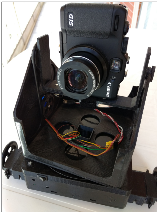
Figura 31 – TiIBOT com câmera na posição retrato, com um lastro de 100 gramas no suporte da câmera destinado a equilibrá-la e montado para executar projetos 360° imersiva
