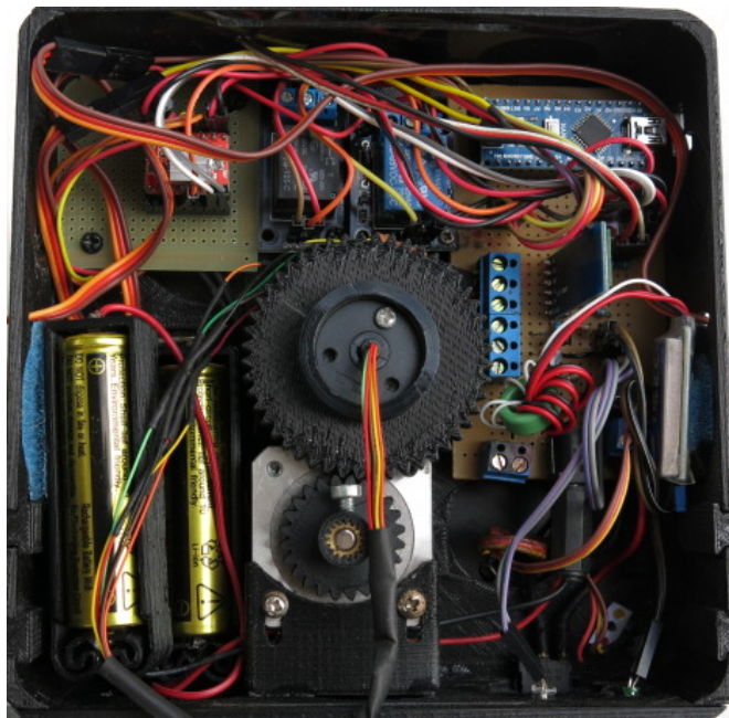
Figura 17 – Componentes eletrônicos e mecânicos do TilBOT montados no Módulo de Sustentação e Movimento. Na imagem é possível identificar o motor de passo, relés, driver , dois LEDs e as baterias de íon lítio. As engrenagens do motor de passo e do eixo principal também podem ser vistas na imagem
