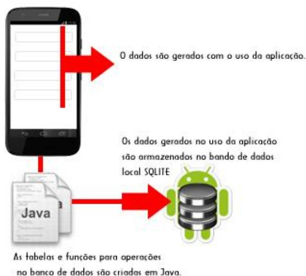
**Figura 10** - Arquitetura de sistema e armazenamento de dados
