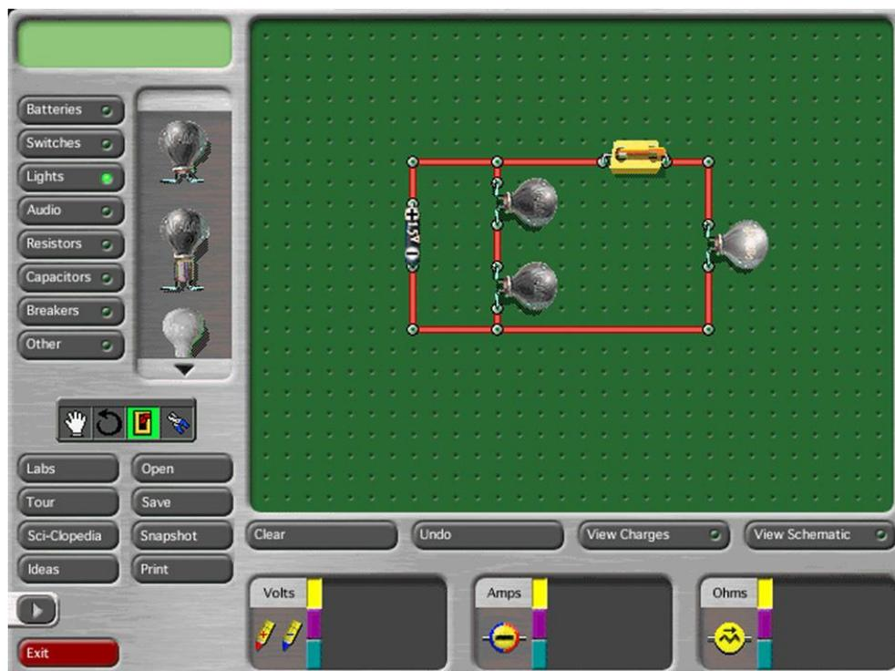
**Figura 11 - Virtual Labs: Electricity, simulador de circuitos elétricos
